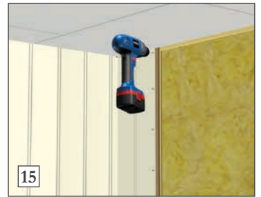
15) Skivan skruvas i noten. Inne i hörnet fästs skivan synligt. Botten och toppen kan skruvas som vanligt. Använd bättringsfärg i originalet på skivan för att dölja skruvhuvuden. Använd penseln som sitter i korken på bättringsfärgsflaskan.
